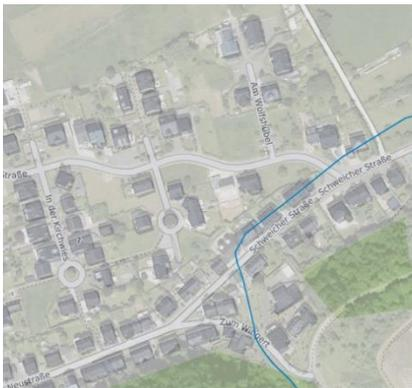
Durch einheitliche Randsteinhöhen oder durch erhöhte Randsteine kann die gerichtete Lenkung des Wassers auf dafür hergerichteten Notentlastungswegen Sachschäden an Gebäuden minimieren. Aktuell sind die Randbereiche der Straße vor allem in den stark gefährdeten Bereichen der Straßenkreuzung Zum Wingert, Neustraße und Schweicher Straße als dreizeilige Rinne ausgebaut, die zwischen Straße und Gehweg abgesenkt ist und somit leicht durch oberflächlich abfließenden Starkregen überschwemmt werden kann.
