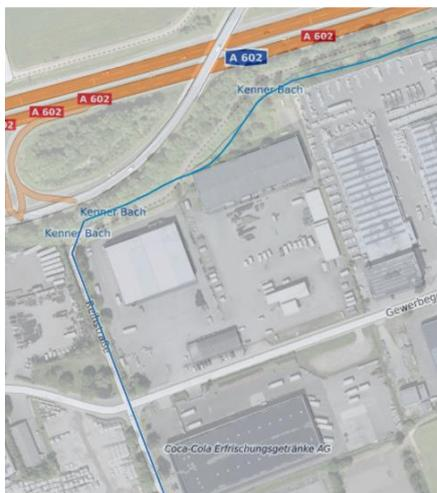
Von den Bürgern wurde im Rahmen der Workshops angeregt, die Verrohrung des Kennerbaches durch den Wiederanschluss eines bestehenden, ungenutzten Kanals auf dem Gelände von Coca-Cola zu entlasten. Bei den darauffolgenden Recherchen konnten jedoch keine Planunterlagen zu einem derart gelagerten Kanal gefunden werden. Die vorliegenden Karten zeigen keinen entsprechenden Kanal.
